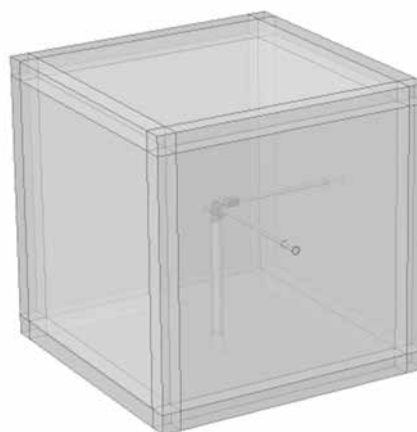
Rys. 1 – Symulacja koronowa. Modelowana domena 3D-FEM
